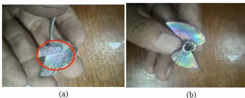
Gambar 3. Cacat oksidasi (a) temperatur tuang 275 °C (b) temperatur tuang 300 °C
