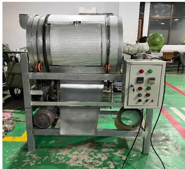
Gambar 3 Hasil perakitan pengering gabah kapasitas 25 kg
