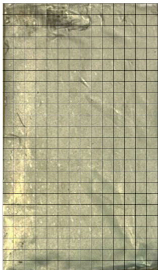
Gambar 2. Metode pengukuran daerah burning
