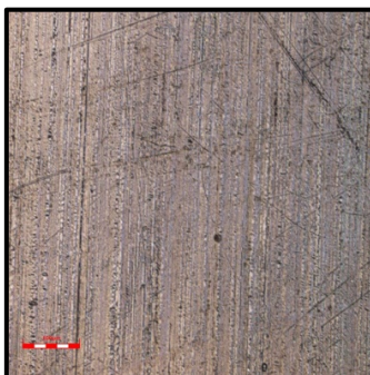
Gambar 3. Foto mikro permukaan aluminium foil non anodizing
