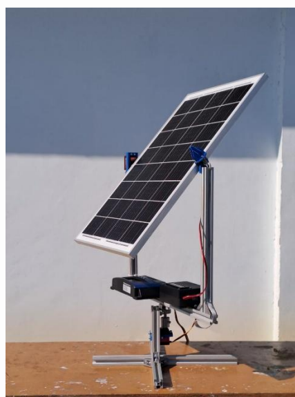
Gambar 8. Panel surya menggunakan solar tracker dual-axis
