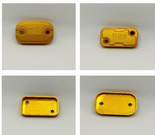
Gambar 8. Hasil anodizing dan dyeing pada tutup master rem
