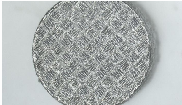
Gambar 5. Kondisi permukaan atas ( upskin ) spesimen SLM Ti6Al4V dengan strategi pemindaian chessboard
