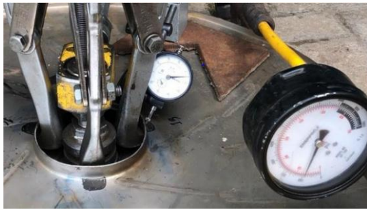
Gambar 5. Uji tarik pada exhaust fan
